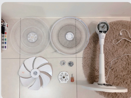
1 拆解電扇，取出網罩、葉片。
