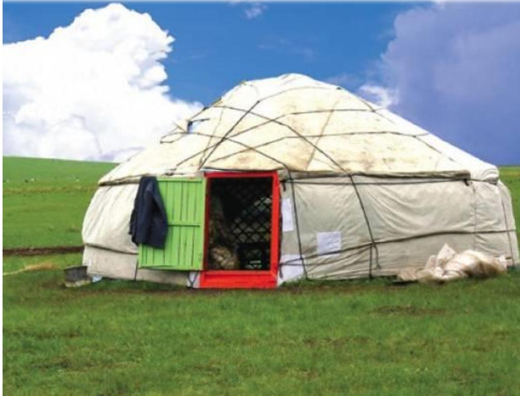
圓弧外形的蒙古包可減寒風威力，傘狀頂部可排除雨雪，加上易於拆建的特點，為蒙古族的傳統住所。
