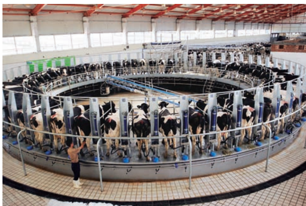
圖 1-3-3 機械化轉盤擠奶設備 內蒙古自治區一家企業化的畜牧場，正大規模生產牛乳及相關產品。
