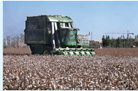
圖 1-3-4 新疆棉花田 一臺自動打包採棉機正採收新疆一處的棉田。
