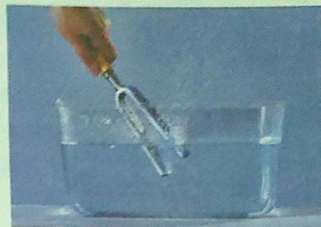
▲ 圖3-9 振動的音叉使水振動並濺起水花。
