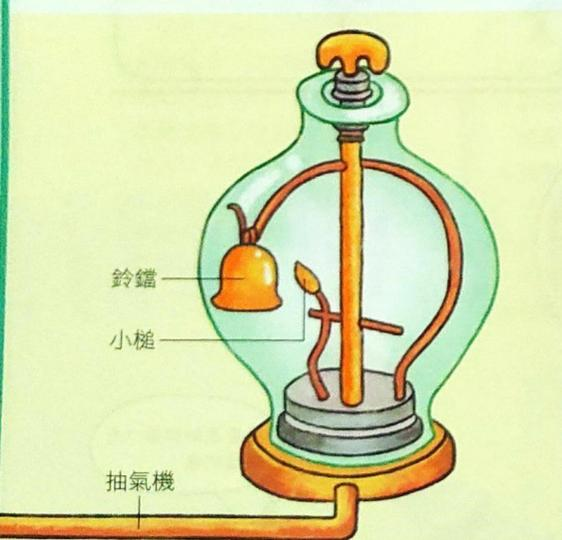
▲圖3-13 波以耳的實驗裝置，以抽氣機將密閉玻璃罩內的空氣抽出，鈴聲就消失了。
