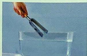
▲ 圖3-8 觀察敲擊過的音叉放入水中後，水面的變化。
