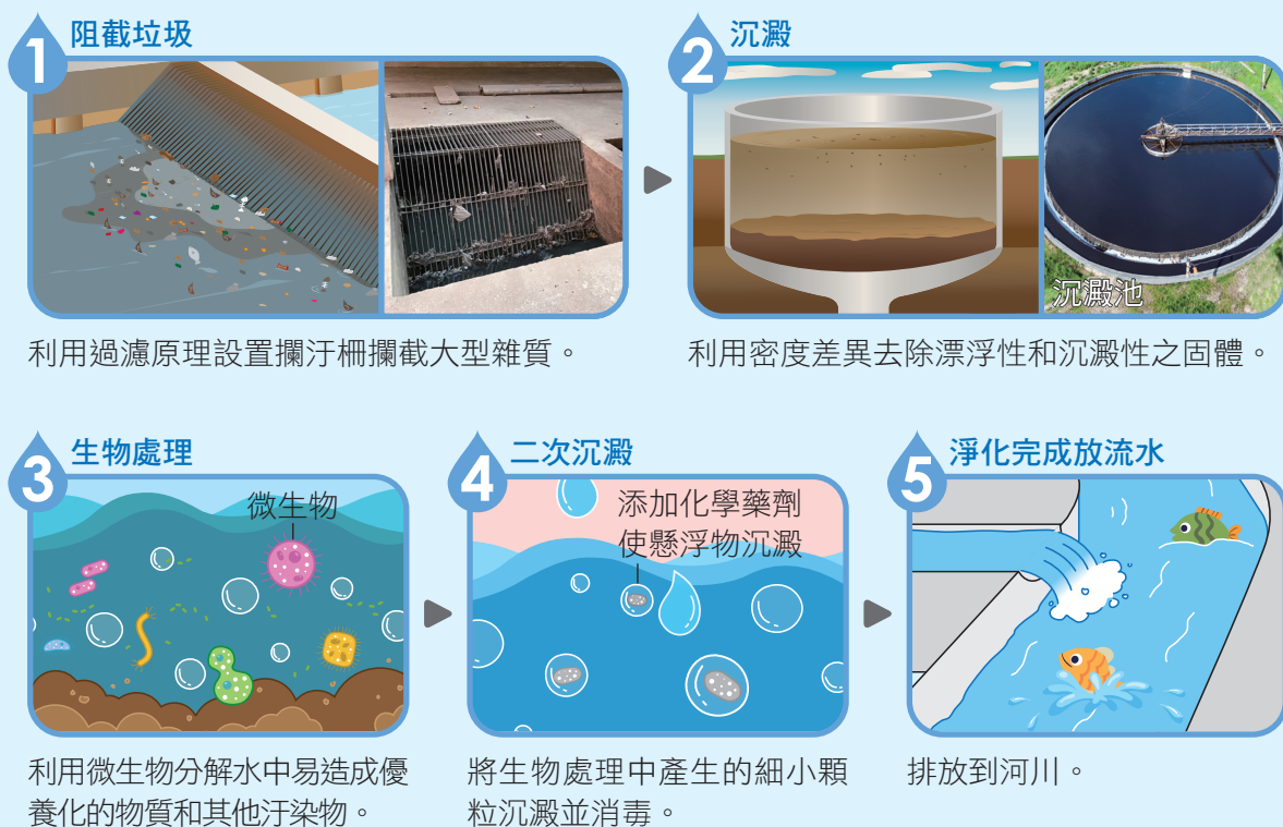
圖2-24 汙水處理流程示意簡圖
