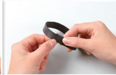
**TIPS** 在要接合的兩個面塗上補胎專用強力膠，切記，兩個面都要塗抹！在補胎專用的膠快要乾掉時，將要接合的兩個面用力壓在一起，確認黏合穩固後，就可以當作傳動皮帶使用了！
