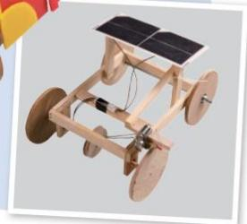
**TIPS** 太陽能動力車仍然可利用電池測試馬達的動力傳輸效果，以隨時調整結構設計。
