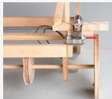
**TIPS** 製作一個可調整的下壓裝置，使摩擦輪向下壓的效果可以達到最佳。
