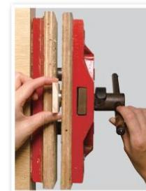
**TIPS** 軸承是輪子轉動時減少阻力的重要零件，軸承的安裝必須將各邊平均施力壓入，可以利用教室中的虎鉗輔助操作。
