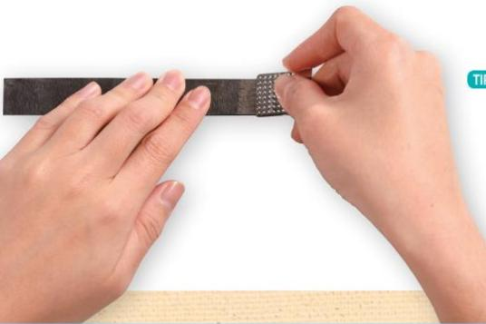
**TIPS** 先利用補胎工具內附的金屬刮片，將要接合的腳踏車內胎刮出一些痕跡，以便補胎膠滲入。
