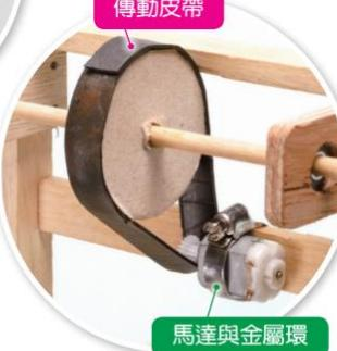
**TIPS** 馬達的動力傳輸出來可以有多種方法，利用可黏合金屬與塑膠的快乾膠，將齒輪黏在馬達的軸上，作為傳輸動力的主動輪使用。
