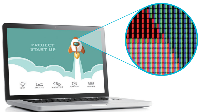
圖4-52 將螢幕畫面放大，可看到許多紅、綠、藍色的小光格，以不同亮度、比例構成不同的色彩。
