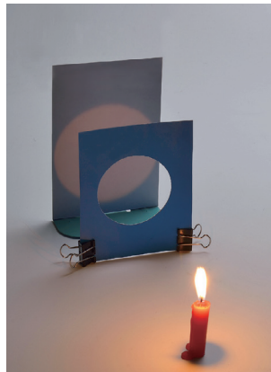
▲ 圖4-4 以燭光照射圓形鏤空紙卡時，後方會形成圓形的明亮區塊。
