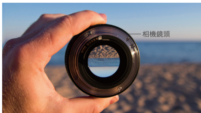
圖4-44 透過相機鏡頭直接觀察物體成像，可看到倒立實像。
