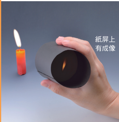
A 針孔成像是光線通過針孔傳播至紙屏所形成的實像。
