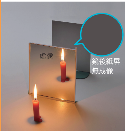
B 平面鏡成像中，光線並非實際傳播至成像位置，故成像為虛像。
