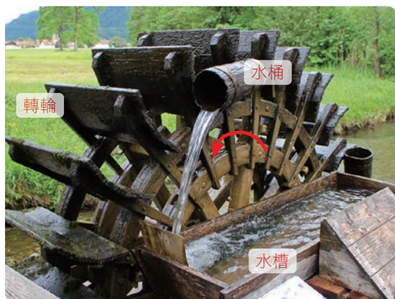
A 筒車是以水流推動加有水桶的水車，水車轉輪下半圈入水時，輪上的水桶裝滿水，待轉輪轉到頂端時，水桶中的水便因為重力傾瀉流入水槽。
