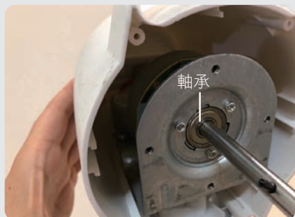
▲ 圖2-1-11 電扇上油保養步驟
