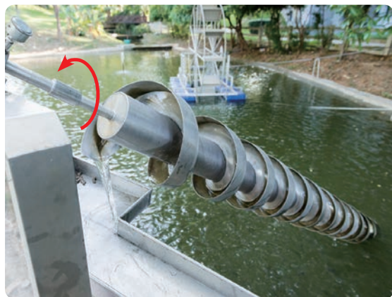
C 阿基米德水車是透過底部開口入水時取水，水隨著螺旋轉動而上升，最後從頂部的開口流出。
