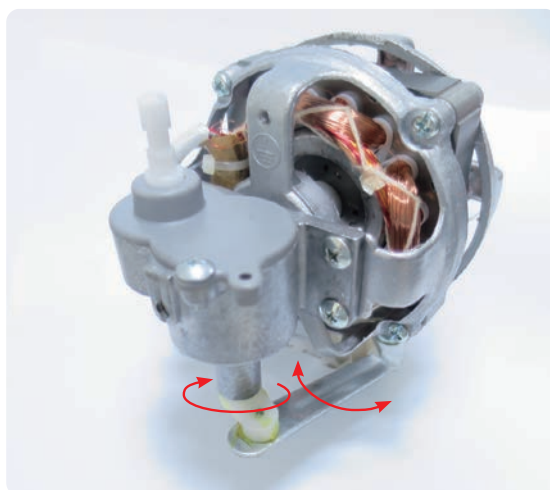
D 電扇擺頭裝置：馬達轉軸帶動連桿，使電扇可以來回擺動。
