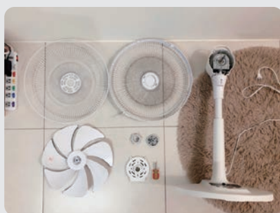
1 拆解電扇，取出網罩、葉片。
