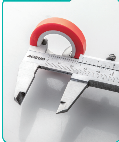
▲圖 3-4 游標卡尺的數值判讀與測量方式。
