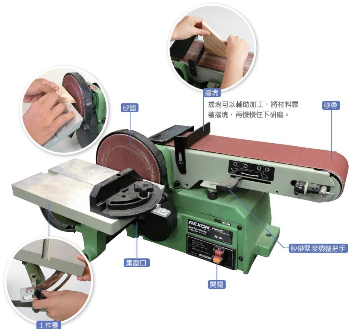
▲圖 13 砂磨機的部件。
