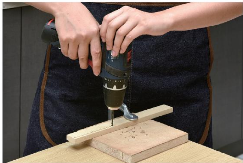
▲圖 4 手電鑽要與木板呈垂直狀態鑽洞。
