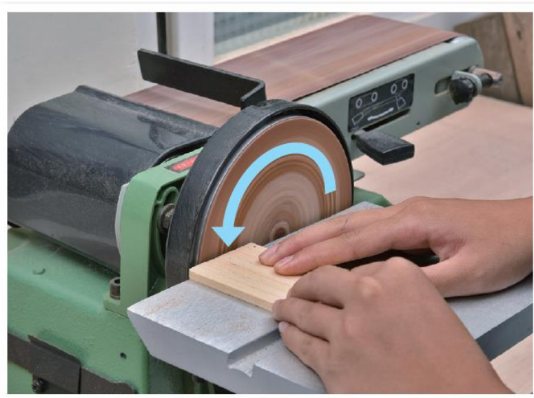
▲ 圖 15 木材只能放置在平板的左半邊，以免回打。 ▲ 圖 16 使用砂帶時，材料可靠著擋塊加工。
