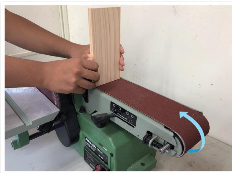
▲ 圖 15 木材只能放置在平板的左半邊，以免回打。 ▲ 圖 16 使用砂帶時，材料可靠著擋塊加工。
