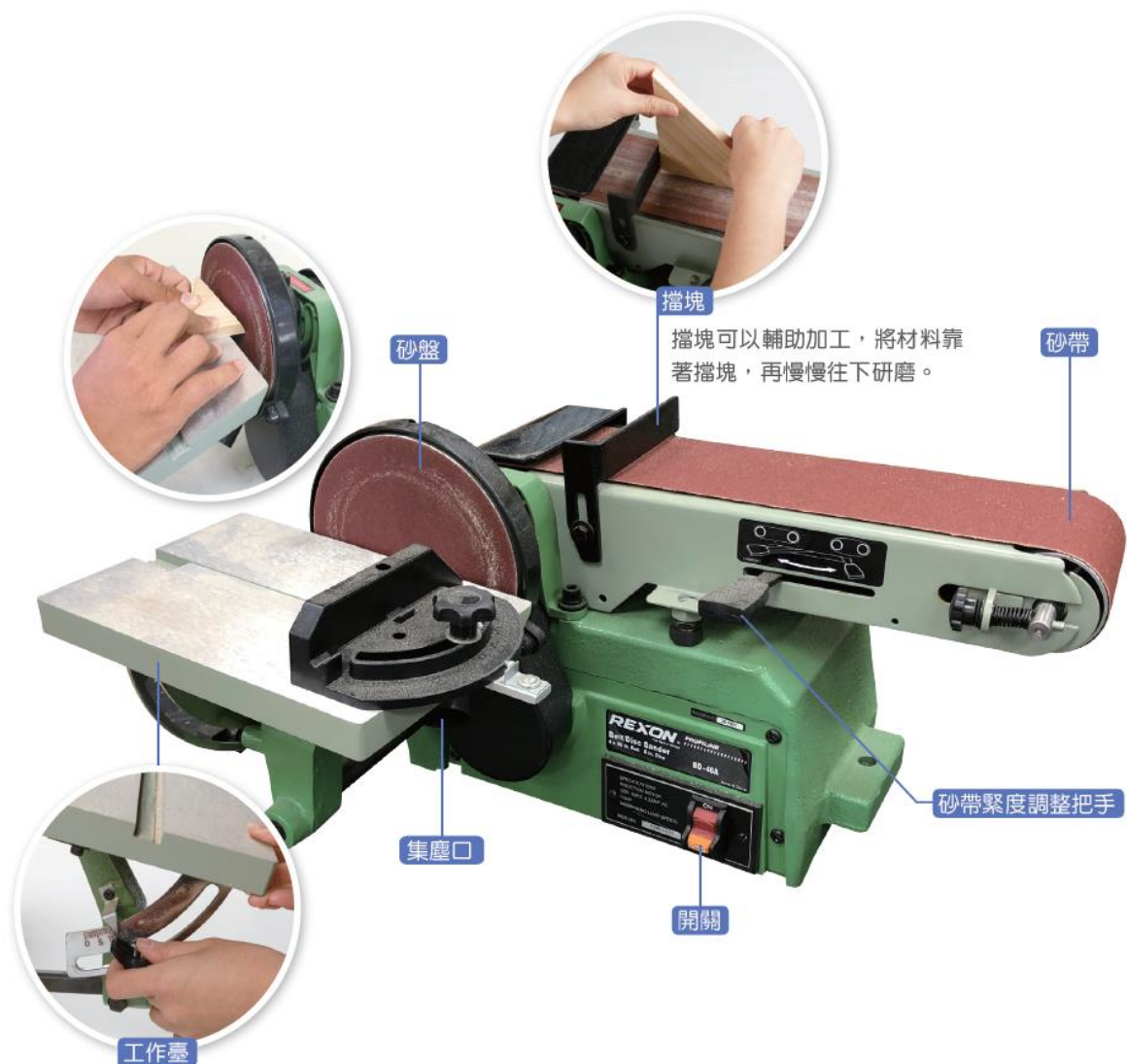
▲圖 13 砂磨機的部件。
