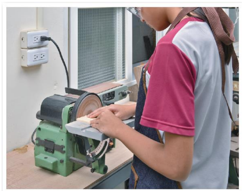
▲圖 14 使用砂磨機務必扶穩物件，並配戴護目鏡。
