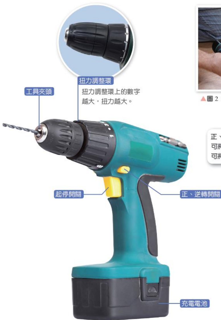
▲圖 1 手電鑽的部件。
