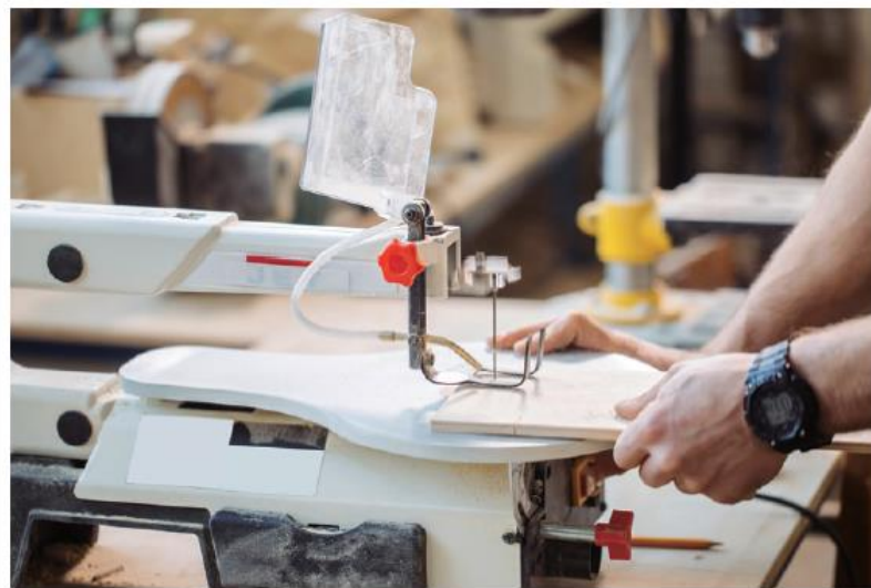
▲圖 7 使用線鋸機可以代替手線鋸，快速地鋸切木板。
