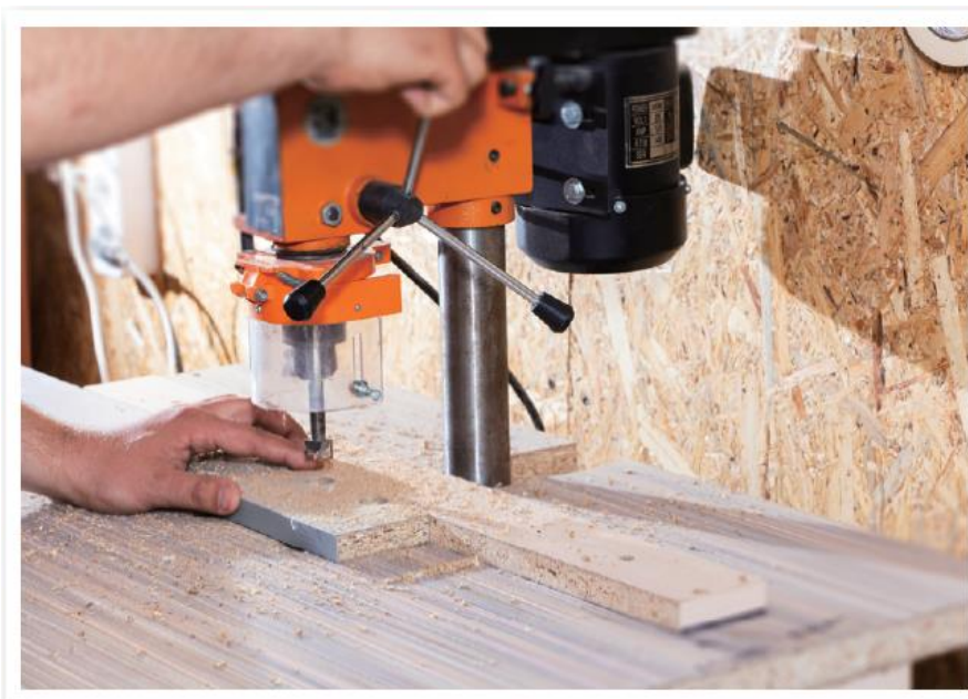
▲圖 12 下壓進給把手讓鑽頭切削要加工的物件。
