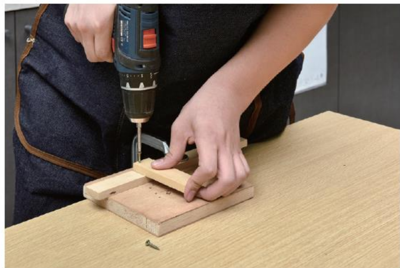
▲圖 5 利用夾具固定物件，並在下方墊上木板。
