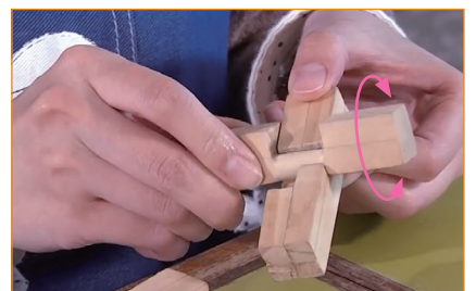
③ 測試圓柱能在組件2中轉動。
