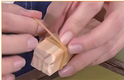
② 以橡皮筋綁緊加壓。
