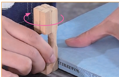
② 適時轉動組件，使砂磨平均。
