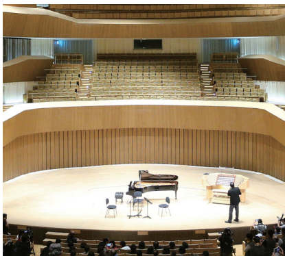
▲ 圖3-27 高雄 衛武營音樂廳後方的弧形牆面可反射樂音至觀眾席
