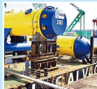
▲ 照片4-10 黑潮發電機
