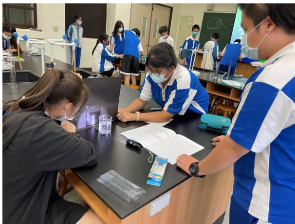
學生利用水杯模擬凸透鏡匯聚光線，測量焦距。
