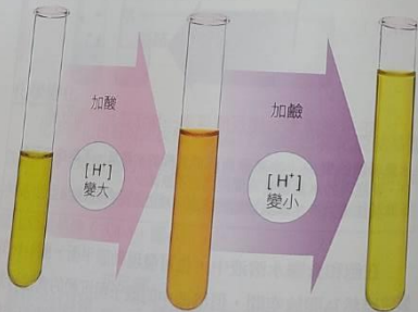
圖4-17 改變氫離子濃度會影響鉻酸鉀溶液的平衡狀態
