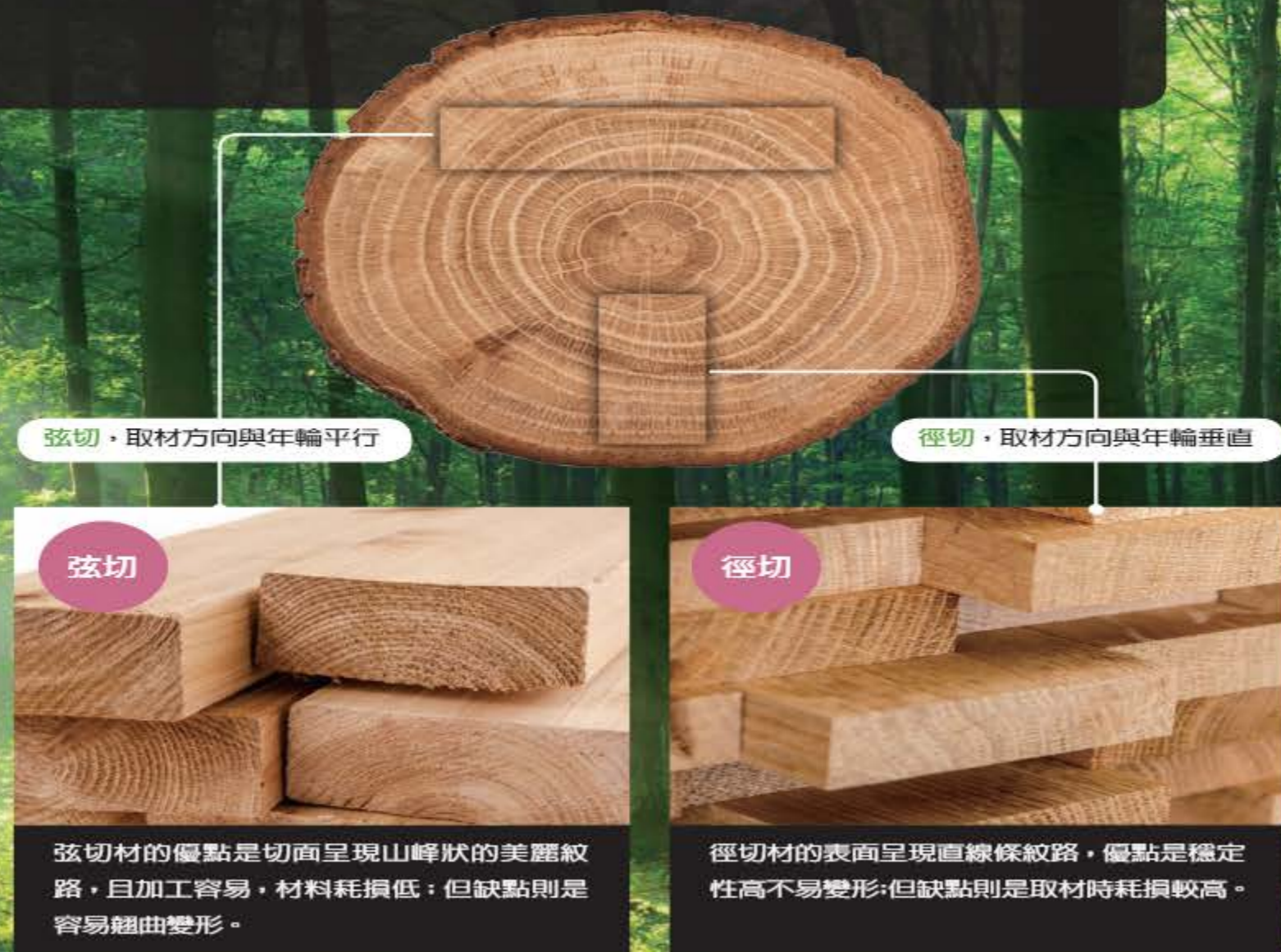
圖 1-18 取木材的切法示意圖
