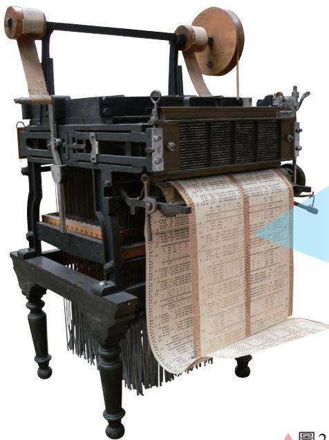
利用設計的孔洞排列，編寫輸入織布的圖案。
