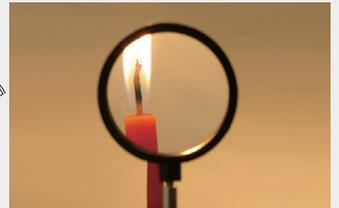
圖4-37 物體經過凸透鏡折射所形成的像。
