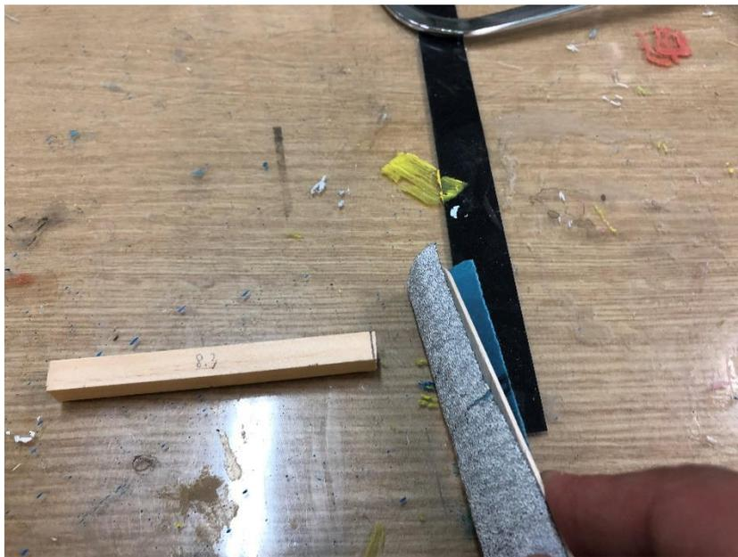
所有平面務必磨平，避免磨成圓弧形，以免接合造成縫隙
