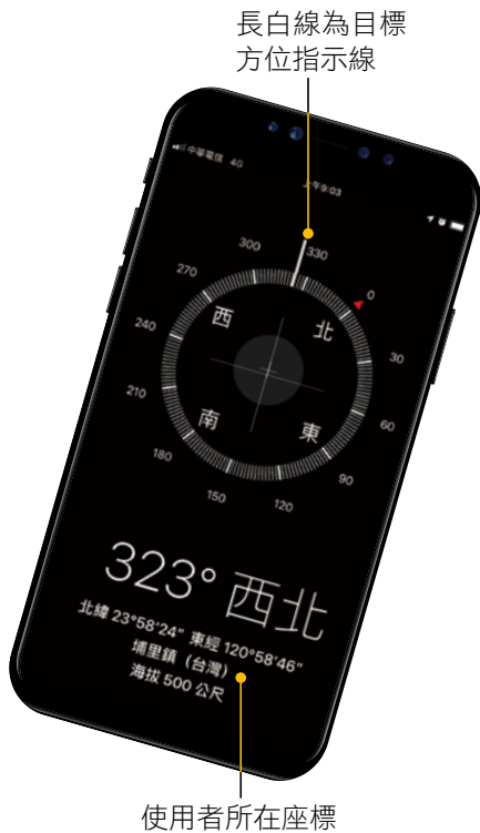
▲圖2-6 行動裝置的羅盤與全球導航衛星系統軟體
