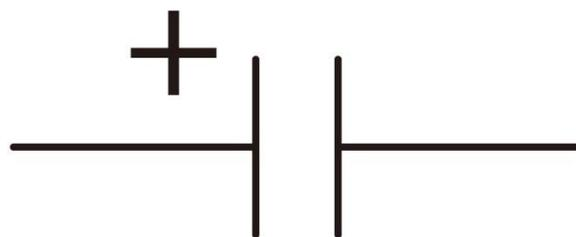
電解電容能承受較大的電壓，常用來穩定電壓。
