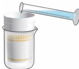
③ 秤取約  $5 \text{ g}$  的硝酸銨，並記錄實際秤得的重量，然後全部加入保麗龍杯中。
