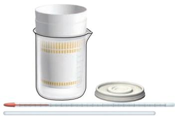
② 用量筒量取  $50.0 \text{ mL}$  蒸餾水加入保麗龍杯中，並放入溫度計，靜置數分鐘，待水溫不變時記錄其溫度。
