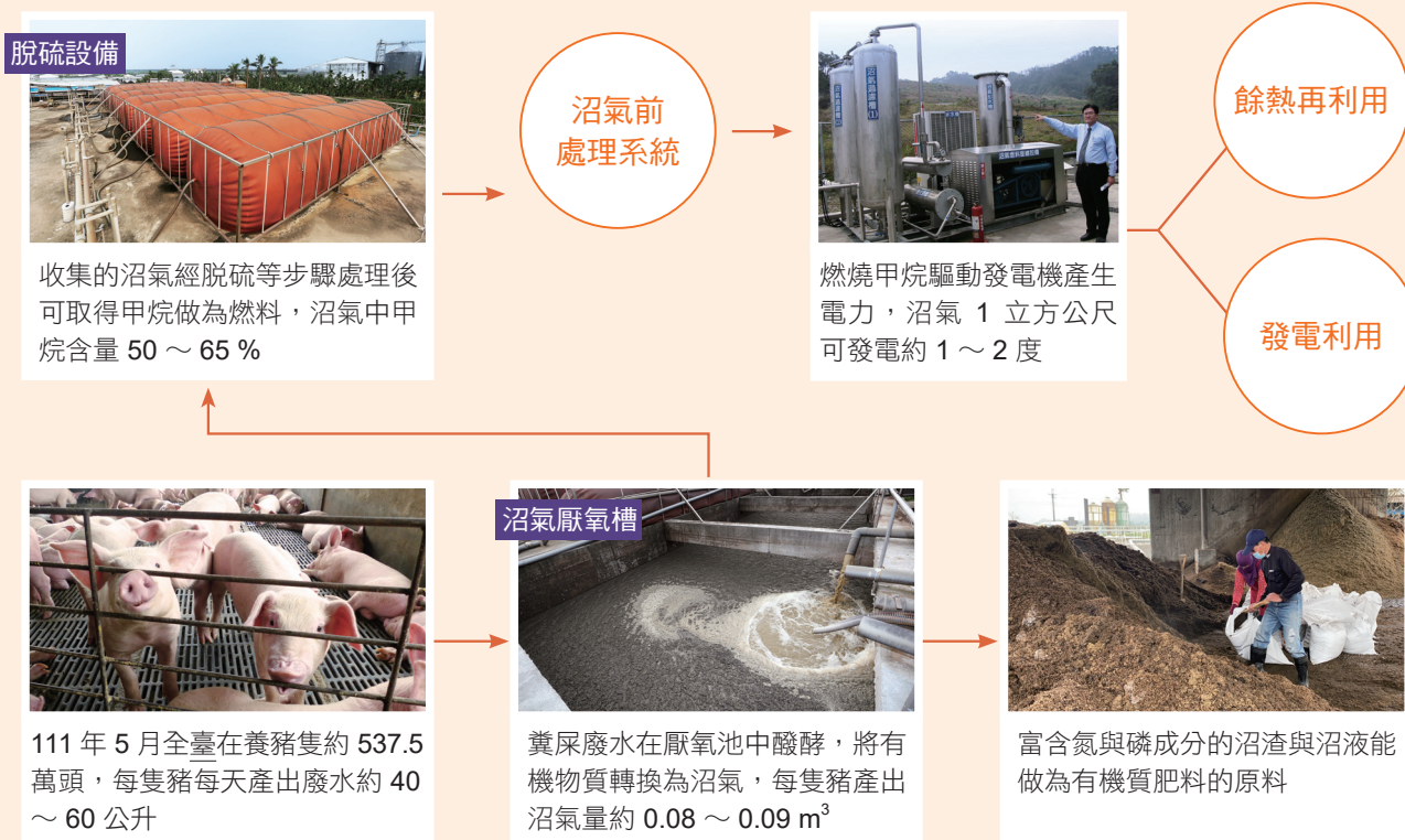
圖 4-22 養豬場沼氣發電系統
