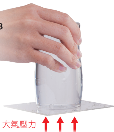
▲ 圖6-25 覆蓋薄塑膠板的滿水玻璃杯，翻轉後薄塑膠板亦不會掉落
