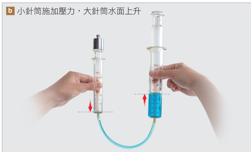
▲ 圖6-23 小針筒活塞上放置砝碼後，可看到小針筒水面下降，而大針筒水面上升
