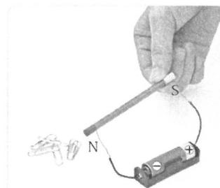
→改變電流方向後，圖中藍色端變為N極，黃色端變為S極，以N極靠近迴紋針時，磁力同樣不足以吸起迴紋針。
