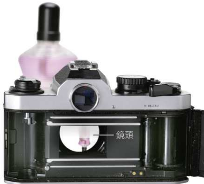
B 將傳統相機機身打開並取出底片後，可透過鏡頭直接觀察物體成像，而看到倒立實像。
