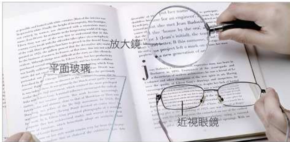
▲ 圖 4-30 平面玻璃、放大鏡和近視眼鏡的成像效果並不相同。
