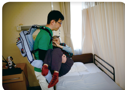
圖2-2-7 外骨骼輔具 / 日本致力發展機械輔具，照護人員可穿戴輔具，減輕勞力負擔。
