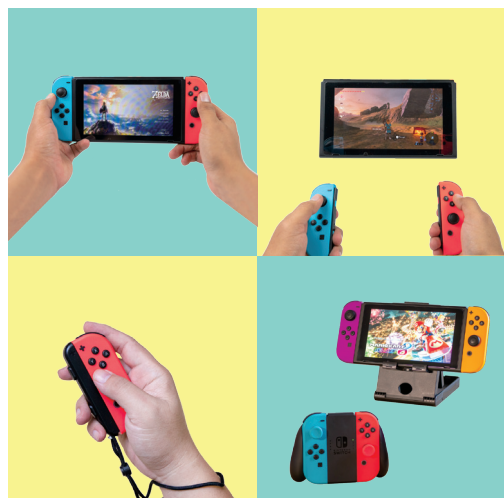
圖2-2-1 Switch / 日本遊戲公司任天堂的產品，能夠藉由卸下或組裝左右兩邊的控制器改變遊玩方式，以及自由選擇連接電視或攜帶出遊的設計，獲得市場不少青睞。
