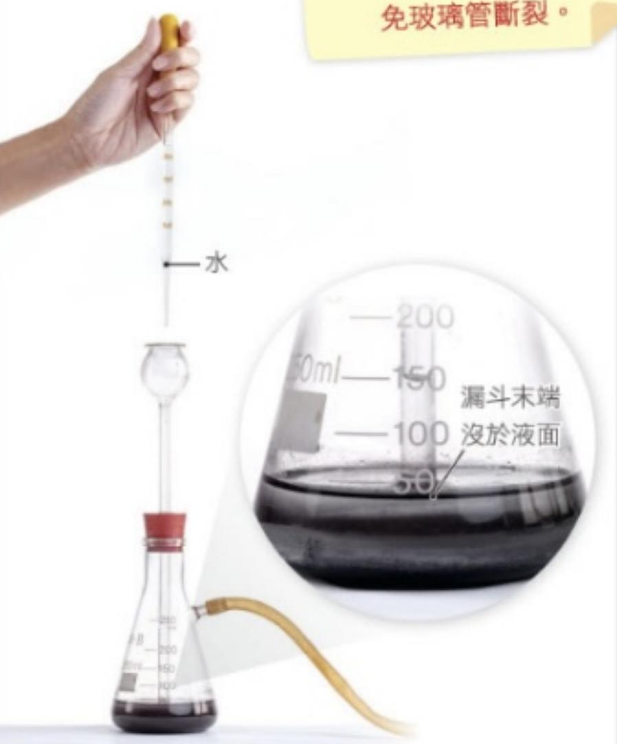
**⚠ 將蓼頭漏斗穿過橡皮塞時，應緩緩旋轉塞入，避免玻璃管斷裂。**
