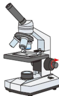
7 觀察視野中的字母方向和實際玻片上字母方向的差異，之後鬆開玻片夾，前後左右微幅移動載玻片，觀察視野中字體移動的方向有何不同。✎紀錄 3
