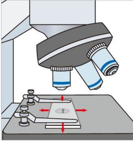
8 將要觀察的地方調整在視野正中央，再轉動旋轉盤，更換較高倍率物鏡觀察。
