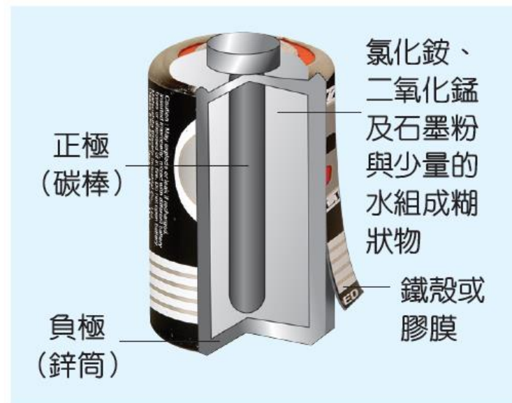
▲圖 1-33 碳鋅電池的內部構造。
