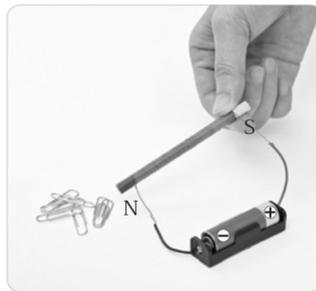
→改變電流方向後，圖中藍色端變為N極，黃色端變為S極，以N極靠近迴紋針時，磁力同樣不足以吸起迴紋針。
