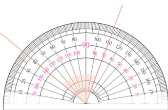
② 先將角的頂點對準量角器中心點，角的兩邊確定在量角器裡面後，再將角的一邊旋轉到任意的刻度線來測量。
