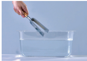
▲ 圖3-8 觀察敲擊過的音叉放入水中後，水面的變化。
