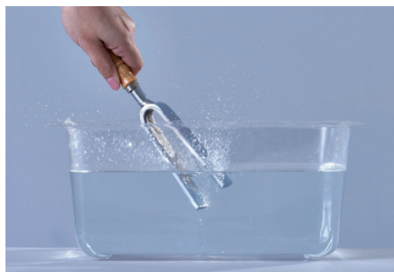
圖3-9 振動的音叉使水振動並濺起水花。
