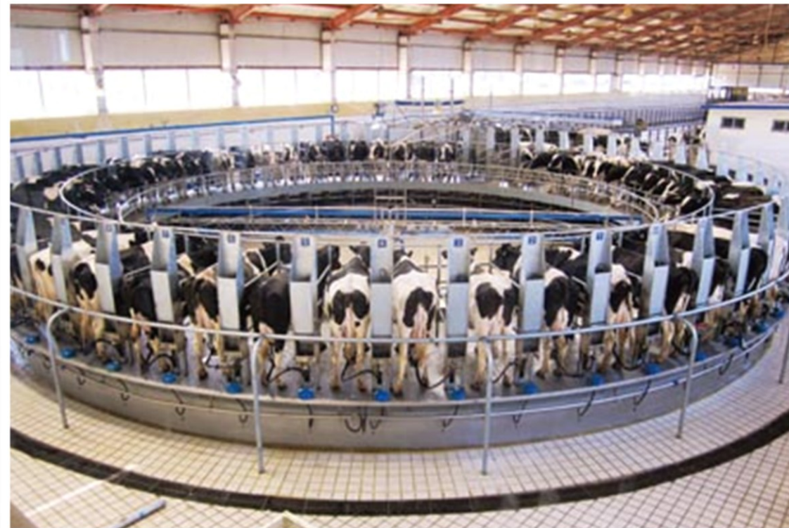
圖1-3-5 機械化轉盤擠奶設備
