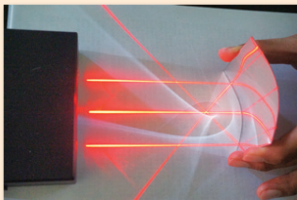
圖 4. 凹面鏡的焦距
