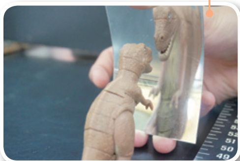
圖 3. 軟鏡教學—凹面鏡成像
